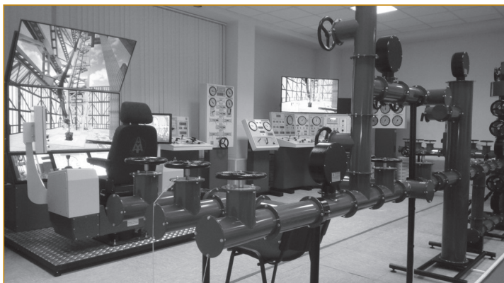
Рис. 5. Комплекс из двух тренажеров бурения – АМТ-231 и АМТ-231КБ (кресло бурильщика), которые могут работать как один тренажер и как два разных
