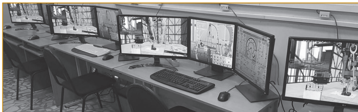
Рис. 4. Участок компьютерного класса тренажера бурения в Самарском государственном техническом университете с трехмониторными рабочими местами, обеспечиваемыми работой трех независимых ведомых клиентов, два из которых демонстрируют реализацию полиморфности
